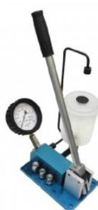
**TESTEADOR Y CALIBRADOR DE INYECTORES DIESEL**
